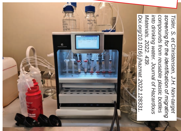
Forskerne foretog en såkaldt non-target screening (NTS) af vandet i drikkedunkene ved hjælp af kromatografi (foto: Selina Tisler).
